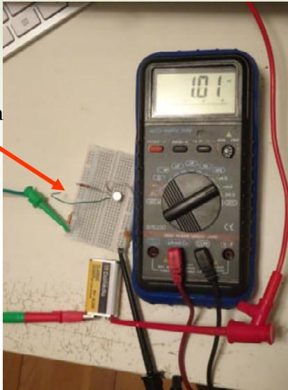
Mesure du courant total ( $I_b + I_c$ ) (collecteur connecté)
