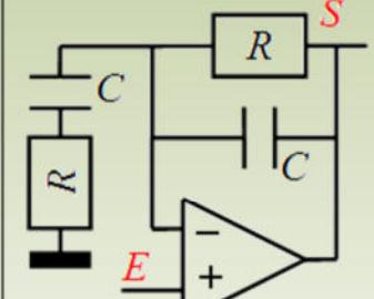
$\text{Filtre de bande 2 cellules (12 dB/oct.)}$ $F(\text{Hz}) = 1 / [2\pi R(Q)C(F)]$ |
