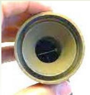
L'antenne (la source) est le barreau au fond du cornet
